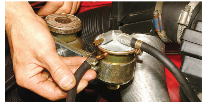
28 Startprobleme bei heißem Motor? Dampfblasen im Kraftstoffsystem sind oft die Ursache
